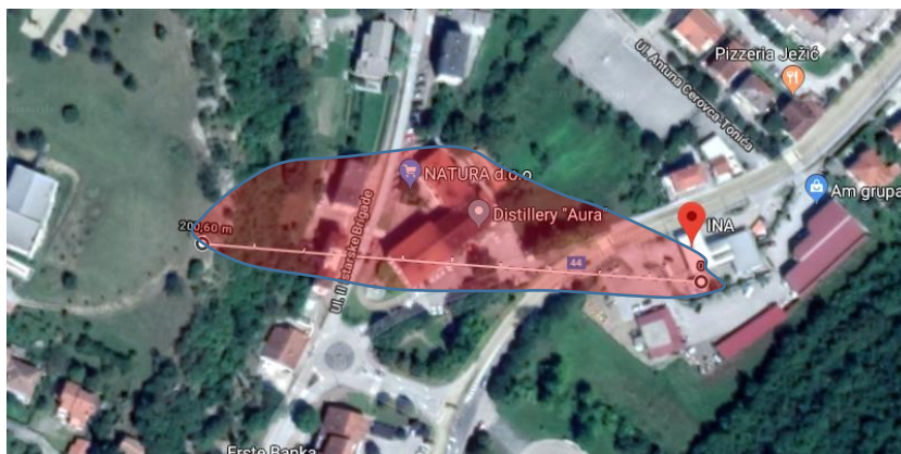
Slika 21: Lokacija BP Petrol-radijus ugroze prema SLAB View metodi Izvor podataka: Planovi i Procjene j.d.o.o.
